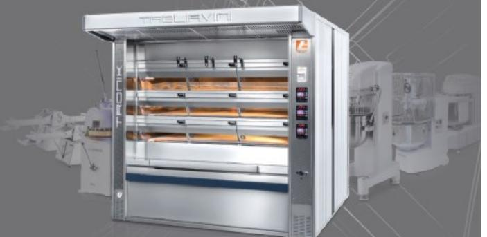
L'optimisateur de consommation SUPERSAVER permet de gérer la demande d'énergie de l'ensemble du laboratoire avec la seule puissance installée du four grâce à la très faible consommation de ce dernier qui n'est que de 1,8 kW/m<sup>2</sup>. Grâce à ce dispositif, on évite toute consommation superflue de kW ce qui diminue d'autant le coût du produit!
