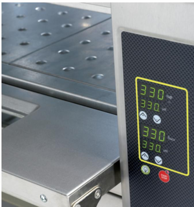
**I nuovi modelli iD sono stati pensati e progettati per offrire la massima versatilità. Il piano di cottura in lamiera bugnata insieme al rivoluzionario controllo elettronico di 2 temperature sono la soluzione ideale per la cottura di pizza in teglia.**
